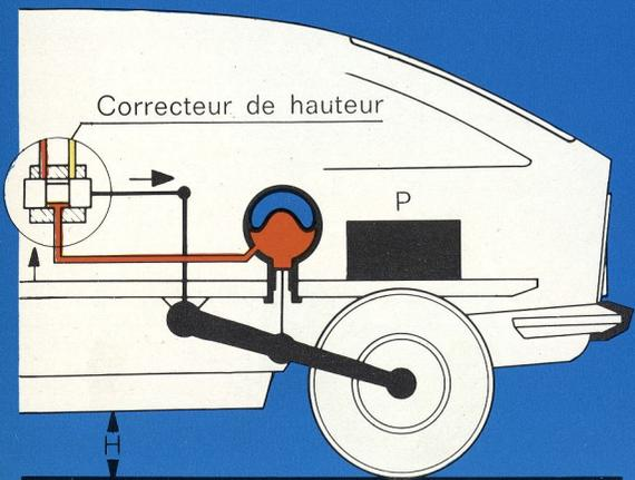
— Chaque roue indépendante est reliée à la caisse par un bras solidaire d'un piston. Ce piston coulisse dans un cylindre, agit sur un liquide qui comprime plus ou moins un gaz sous pression contenu dans une sphère. Ce gaz joue le rôle d'un ressort pneumatique. A tout enfoncement du piston, provoqué par le déplacement vertical de la roue, correspond une diminution du volume de gaz.
